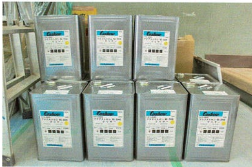
アクリルクリアワックス材 (2剤硬化型)
