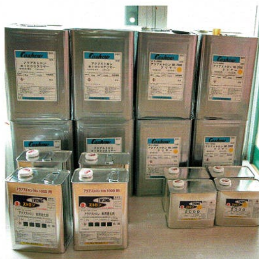
使用する透明クリアーのポリウレタン塗料 耐久性と撥水・防汚性能に優れています。 左2列が下塗り用、右2列が上塗り用。
